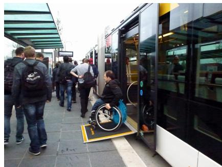
▲バス停は車両からスロープを自動で出し入れできる高さにし、介助なしで乗降できる。道路と車両のトータルで都市交通がデザインされている
